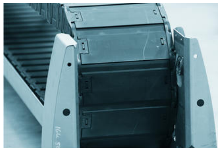
2. Rullstöden trycks in och fälls ut igen när kedjan har passerat
