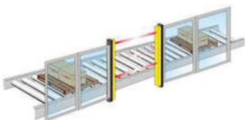
Kroppsskydd med 2 strålar (skyddsfält 500 mm)
