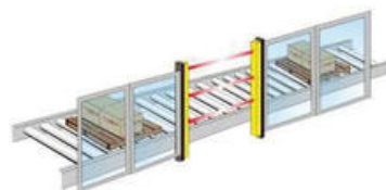
Kroppsskydd med 3 strålar (skyddsfält 800 mm)
